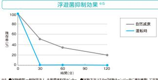
※5 ●試験機関:一般財団法人 北里環境科学センター ●試験方法:12.5m<sup>3</sup>試験チャンバー内に菌を噴霧して浮遊させた後、移動型ナノフィールをうるおい加湿の風量レベル3(約2.5m<sup>3</sup>/min)、加湿レベル1の条件で空清フィルターを付けて運転し、浮遊している菌の数を経時的に測定。 ●報告書番号:北生発2017\_0004号
