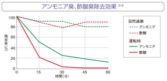
※4 ●当社調べ ●試験方法:容積21.4m°の試験室(5.5畳相当)で各臭気成分を噴霧し、自然減衰と運転時の各種臭気成分濃度をガス検知管で測定。(当社基準)
