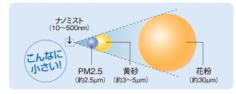
●当社調べ ●試験方法:容積21.4m3の試験室(5.5畳相当)で試験用粒子状物質を散布し、自然減衰と運転時の各サイズの粒子数をパーティクルカウンターで測定。(当社基準)
